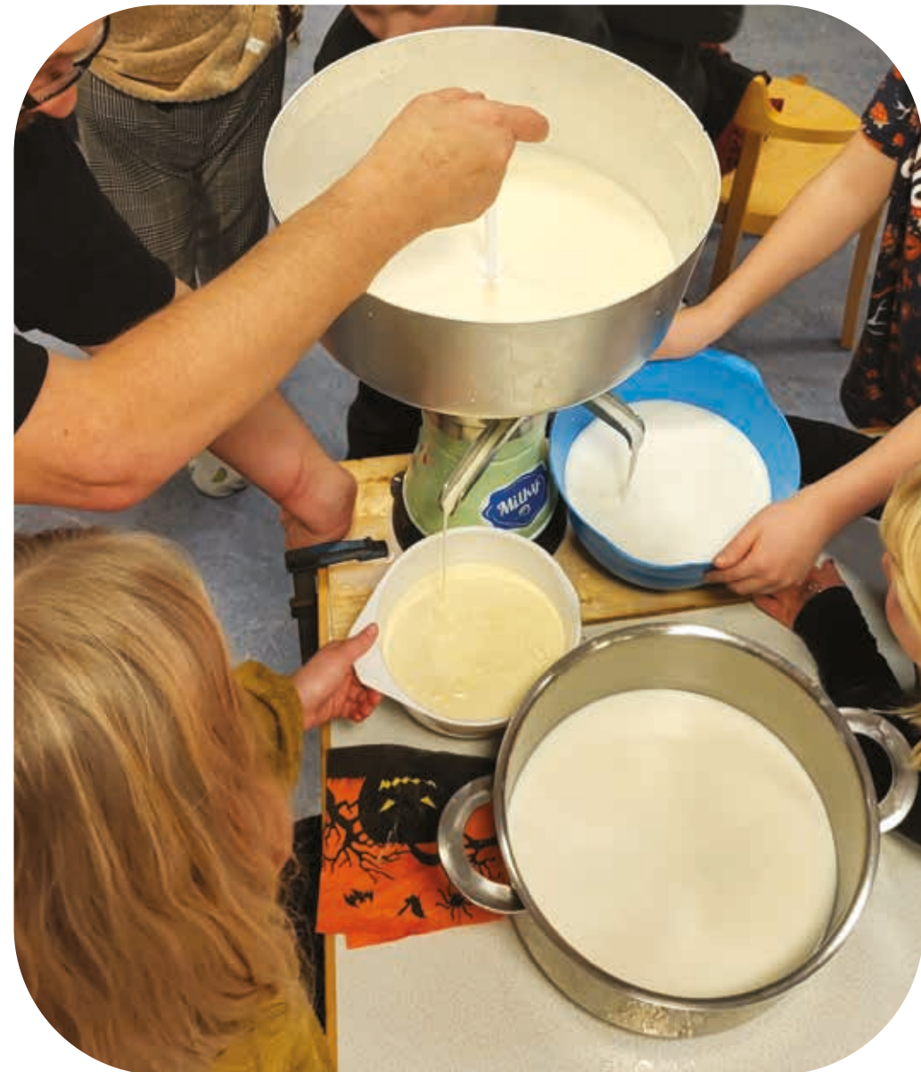
Kuvassa näkyy, kuinka tuore lehmänmaito erotetaan rasvattomaksi maidoksi ja kermaksi separaattorin avulla. Kuva: Virve Lanto.
